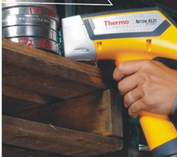
无论是在重工业、建筑、生产制造、石油化工、废金属回收或者电力行业，金属成份鉴别一直扮演着极其重要的角色，由于环境、场所，被测金属体积、重量、运输等客观因素的影响，金属成份鉴别的费用一直居高不下，Thermo Scientific Niton XRF的便携设计、优异性能、完善配置为众多客户在现场快速提供接近实验室精度的金属成份。
