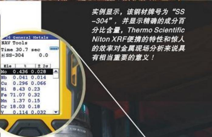
实例显示，该钢材牌号为“SS-304”，并显示精确的成分百分比含量，Thermo Scientific Niton XRF便携的特性和惊人的效率对金属现场分析来说具有相当重要的意义！
